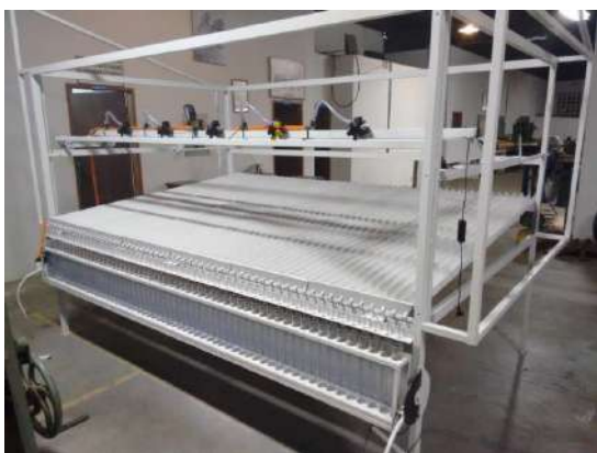
Figura 1. Bancada padrão para testes de distribuição.
