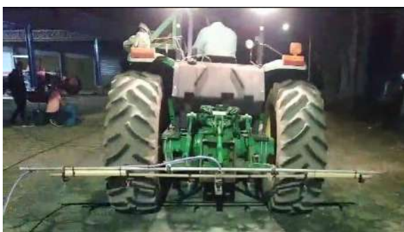
Figura 1. Trator John Deere 4x2 TDA com a barra de pulverização acoplada, contendo as seis pontas de pulverização.
