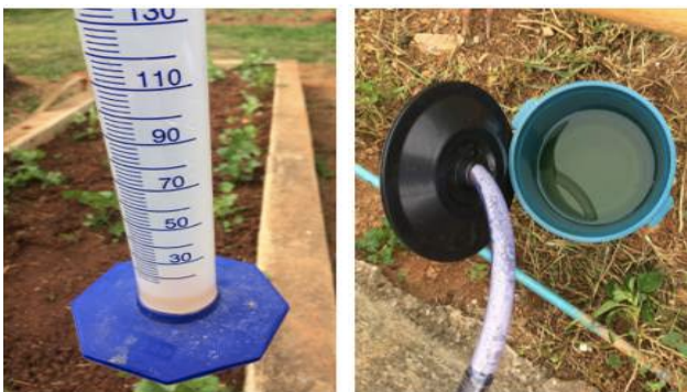
Figura 1. Recipiente utilizado para quantificação da quantidade total drenada em mm (a) Recipiente utilizado para captação da drenagem (a) e proveta utilizada.
